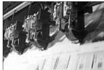
Ausschließlich speziell für dieses Verfahren entwickelte Farben finden hier Verwendung. Acht bis 32 Seiten im DIN A4-Format können pro Maschine gleichzeitig gedruckt werden. Das heißt, wenn beide Maschinen produzieren, sind insgesamt 64 Seiten im Achter-Sprung möglich.
